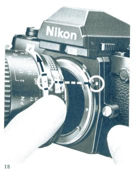
Tome el objetivo por su anillo de montaje. Coloque el objetivo en la montura de bayoneta de la cámara, alineando la referencia de abertura situada en el objetivo con la referencia de montaje de la cámara y gírelo en sentido contrario a las agujas del reloj hasta que quede asegurado en su lugar.
